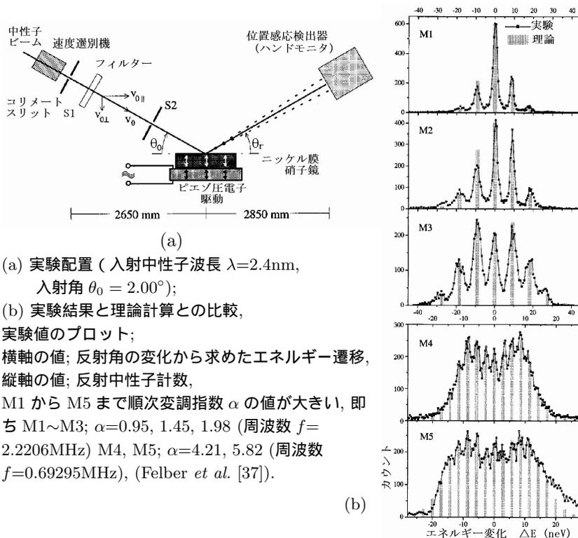
図 1.9: 極冷中性子の振動鏡反射実験
